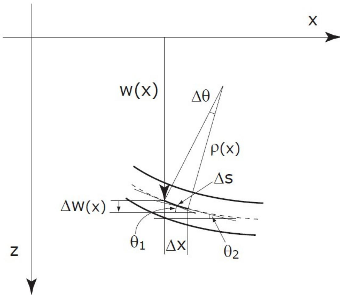
図2：たわみ変形  $w(x)$  と局所半径  $\rho(x)$  の図示 ( $w(x)$  と  $\rho(x)$  の関係)，ここで点線は部材軸 (= 中央部分)
