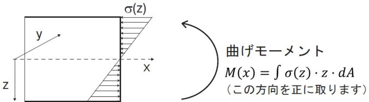
図 4 : 曲げモーメントの概念図
