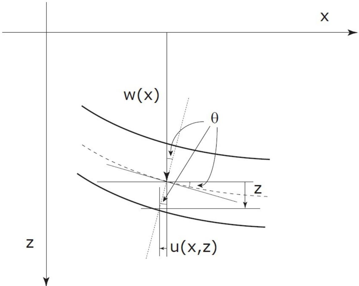
図 3 : x 方向変位  $u(x,z)$  と  $w(x)$  の図示 (曲率  $\rho$  とひずみ  $\varepsilon$  の関係), ここで点線は部材軸 (= 中央部分)
