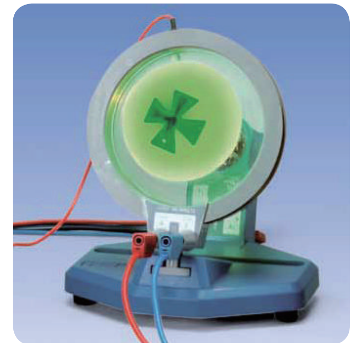
図2: 管軸方向の磁場を印加することで十字の影が回転しています
